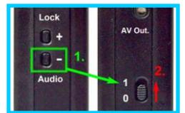
11. **偵測 WiFi 數位封包攝影機**：在「自動掃描」狀態，按一下左側的(-)按鈕，本機將切換到 WiFi 數位封包偵測。首先藍色 LED 跳在 2.4G，綠色 LED 將逐個頻道駐留幾秒鐘後移動，以偵測 WiFi 數位封包的活動。
